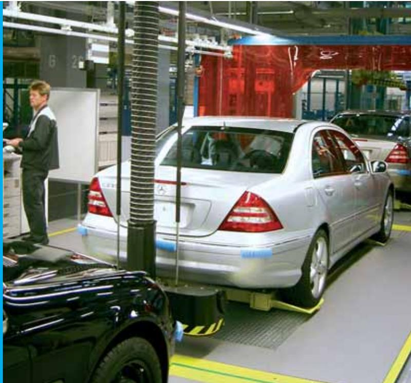
*Fahrzeuge im Erststart, in Prüfständen, bei Einstellarbeiten: Überall sorgen vollautomatische NORFI Abgas-Absauganlagen für frische Luft.*
