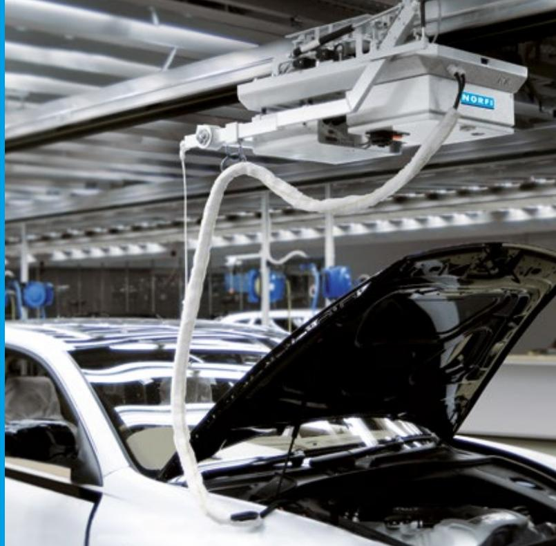
Bei der Kfz-Produktion ergibt sich häufig der Bedarf, die Batterien der Fahrzeuge während der Montage zu laden. Ohne eine Aufladung verlassen die Fahrzeuge den Finish-Bereich mit teilgeladenen Batterien, was ein Nachladen in der Nacharbeitszone erfordert. Um diese Nacharbeit zu vermeiden, bietet es sich an, die Fahrzeuge während der Arbeiten an Ladegeräte anzuschließen.
